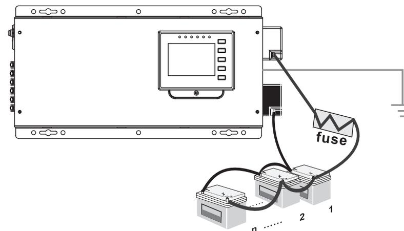
При подключении более одного аккумулятора к инвертору 12В, подключение необходимо осуществлять параллельно, чтобы суммарное напряжение было равно 12В.
