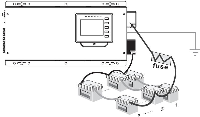
При подключении более двух аккумулятора к инвертору 24В, подключение необходимо осуществлять параллельными группами, чтобы суммарное напряжение было равно 24В.
