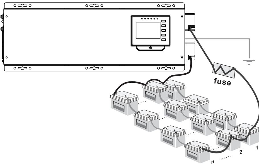
При подключении более четырех аккумуляторов к инвертору 48В, подключение необходимо осуществлять параллельными группами, чтобы суммарное напряжение было равно 48В.
